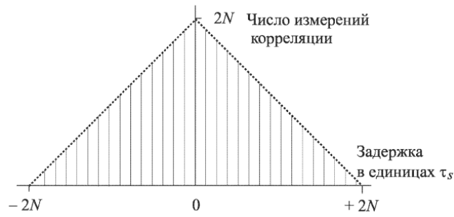
Рисунок 2.3: Число эффективных корреляций в ФХ-корреляторе как функция задержки между отсчетами. N равно числу частотных каналов в полосе сигнала. Иллюстрация заимствована из Книги [18].
