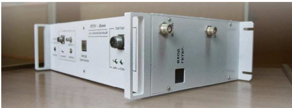
Рисунок 3.3: Общий вид приемо-преобразующего устройства для радиометра 8 мм. Внутри устройства установлен гетеродин диапазона 7-9 ГГц. Результат соавторов из работы [B4**].
