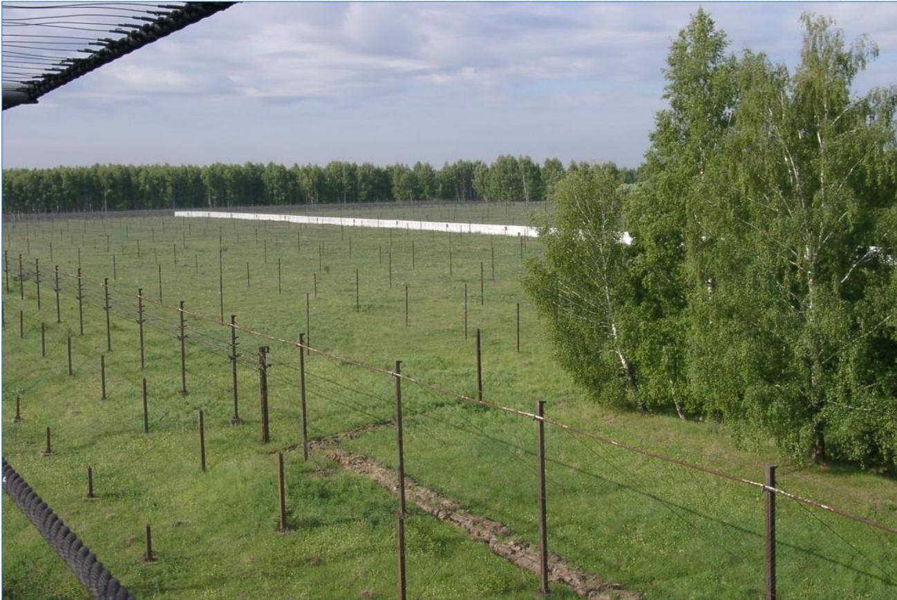
Наблюдения межпланетных мерцаний проведены на радиотелескопе БСА ФИАН, частота 11 МГц, полоса приема 600 кГц, постоянная времени 0.1 с.
