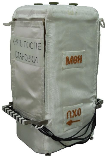
СПИН-Х1-МВН с экранно-вакуумной теплоизоляцией
