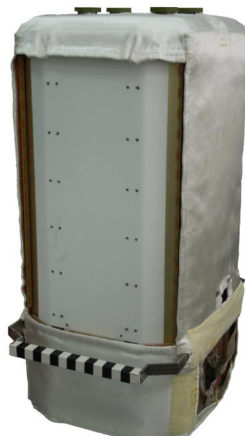
СПИН-Х1-МВН с экранно-вакуумной теплоизоляцией
