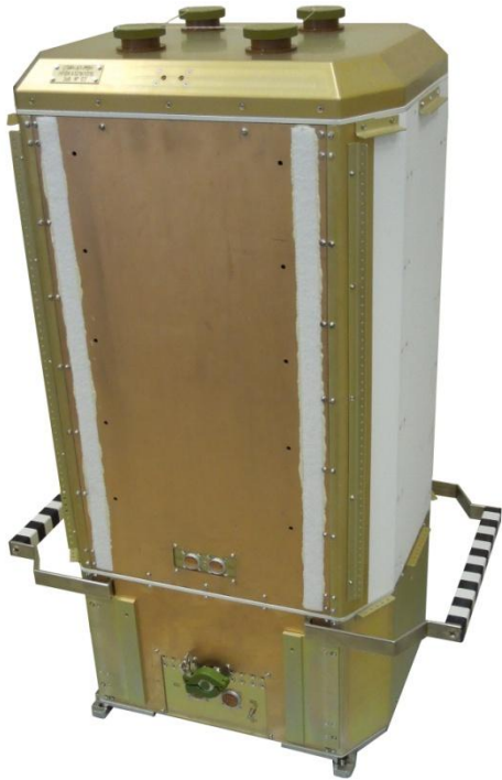
Рентгеновский монитор СПИН-Х1-МВН (лётный образец)
