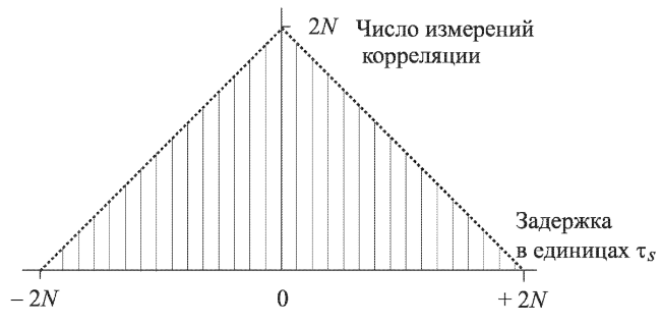
Рисунок 2.3: Число эффективных корреляций в FX-корреляторе как функция задержки между отсчетами. N равно числу частотных каналов в полосе сигнала. Иллюстрация заимствована из Книги [45].
